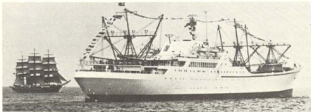
2. De „Savannah” het eerste door kern-energie aangedreven koopvaardij-schip. De „Savannah” meet 21.000 ton en ontwikkelt 20.000 pk. uit de reactor. Met 600 kg splijtstof kan het schip 3 1/2 jaar varen.
